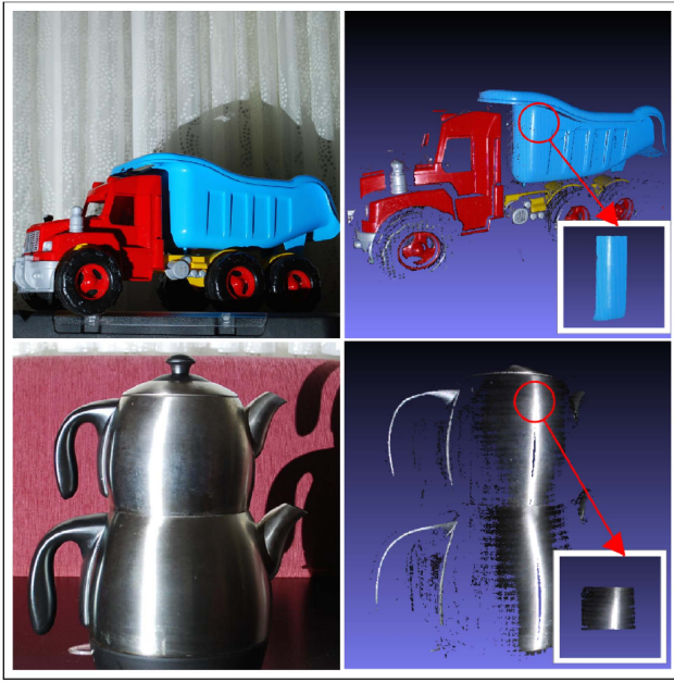
Şekil 5: Aynasal yansımaya özellikleri gösteren örnek yüzeylerin geri çatım sonuçları. Sağdaki resimlerde görüldüğü şekilde aynasal yansımaya özelliklerinin gözlemlendiği alanlar seçildiği takdirde yüzeyin yansıtıcılık özelliklerinin belirli bir oranda geri çatımı mümkün olabilmektedir (bkz. Şekil 6).
