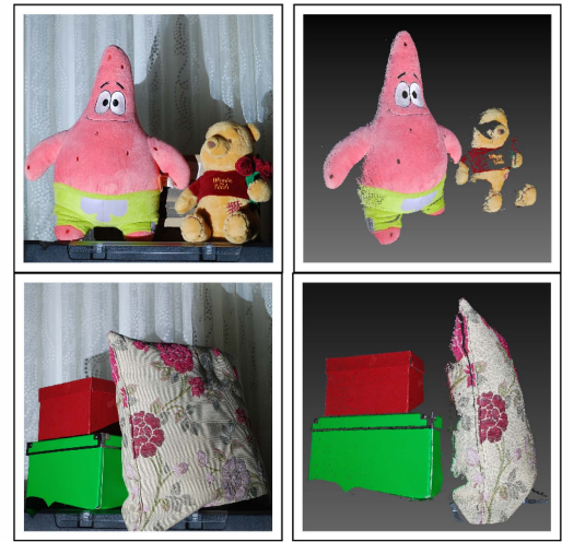
Şekil 4: Solda sahnenin gerçek görüntüsü sağda ise seçili alanda geri çatılmış nokta bulutu resmi görülmektedir.
