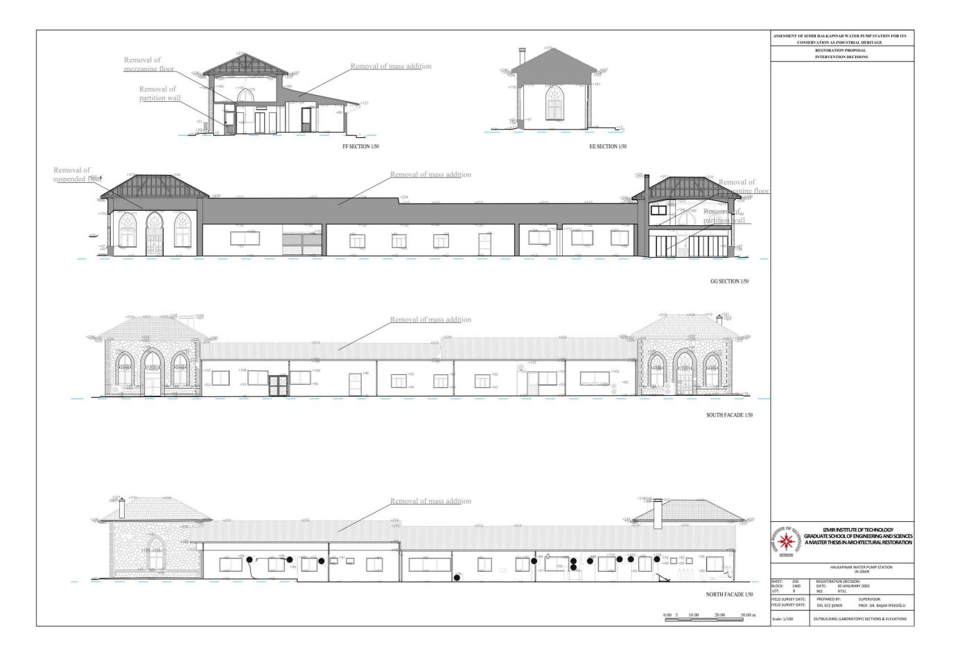
Figure F.1.8. Intervention decisions – Outbuilding Elevations & Sections redrawn from Semra Emek (Asmira Mimarlık-Restorasyon), İzmir Halkapınar Tarihi Pompa Binası Röleve, Restitüsyon, Restorasyon Projesi, 2012
