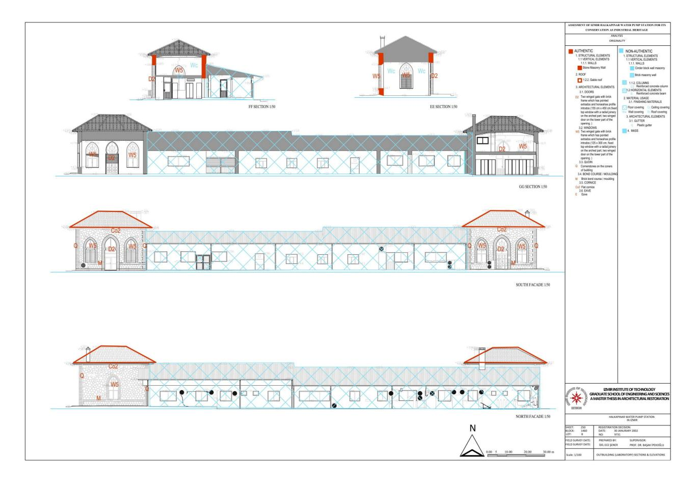
Figure C.3.7. Originality – Elevations & Sections redrawn from Semra Emek (Asmira Mimarlık-Restorasyon), İzmir Halkapınar Tarihi Pompa Binası Röleve, Restitüsyon, Restorasyon Projesi, 2012
