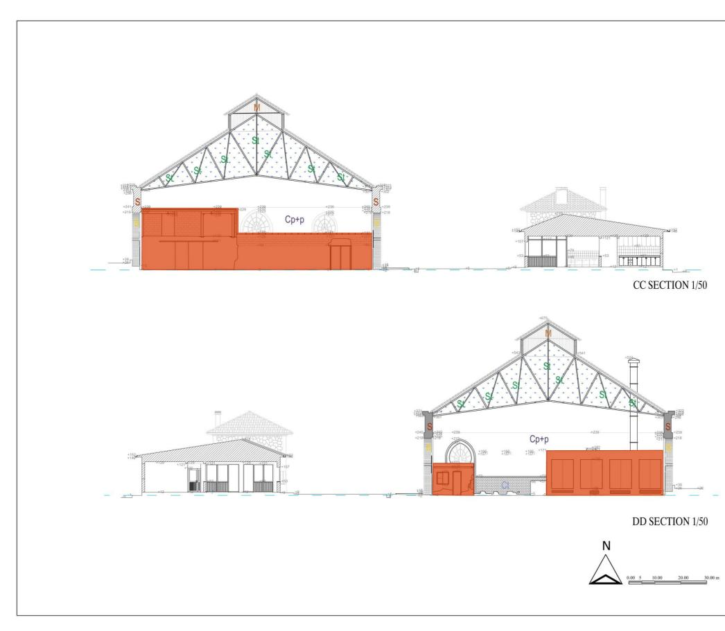
Figure C.1.4. Construction technique and material usage –Sections redrawn from Semra Emek (Asmira Mimarlık-Restorasyon), İzmir Halkapınar Tarihi Pompa Binası Röleve, Restitüsyon, Restorasyon Projesi, 2012
