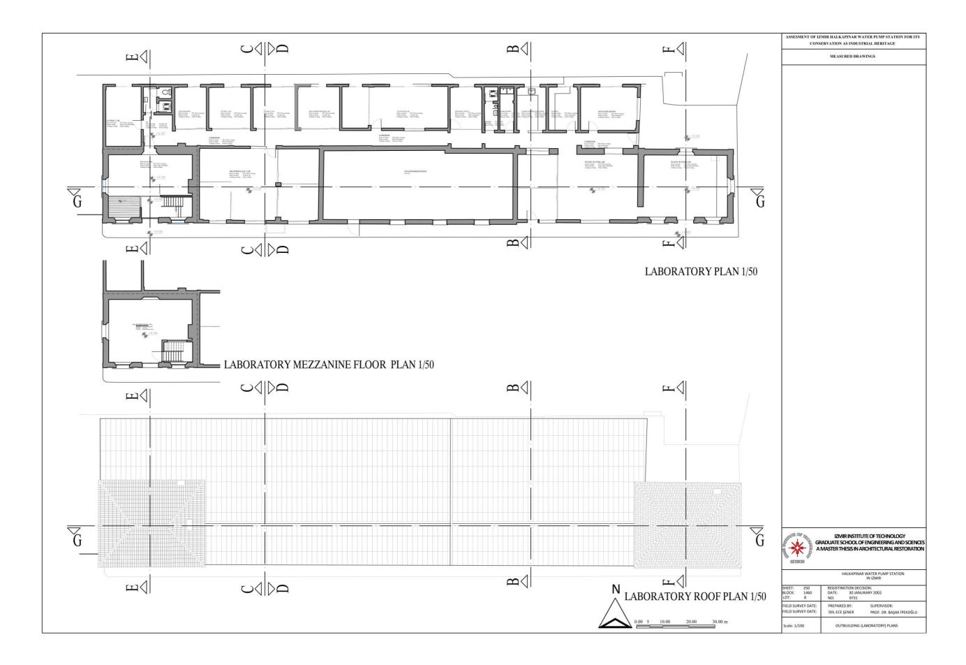
Figure B.8. Measured Drawings Outbuilding Plan redrawn from Semra Emek (Asmira Mimarlık-Restorasyon), İzmir Halkapınar Tarihi Pompa Binası Röleve, Restitüsyon, Restorasyon Projesi, 2012
