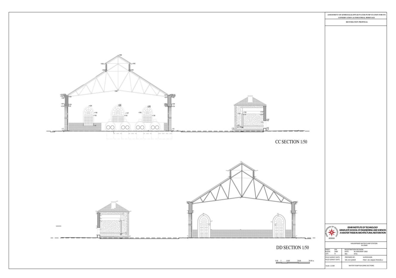
Figure F.2.5. Restoration proposal – Sections redrawn from Semra Emek (Asmira Mimarlık-Restorasyon), İzmir Halkapınar Tarihi Pompa Binası Röleve, Restitüsyon, Restorasyon Projesi, 2012
