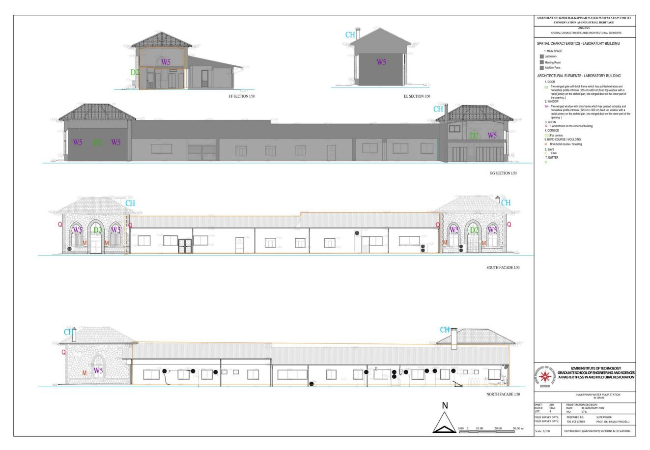
Figure C.2.8. Spatial characteristics and architectural elements –Outbuilding Elevations & Sections redrawn from Semra Emek (Asmira Mimarlık-Restorasyon), İzmir Halkapınar Tarihi Pompa Binası Röleve, Restitüsyon, Restorasyon Projesi, 2012
