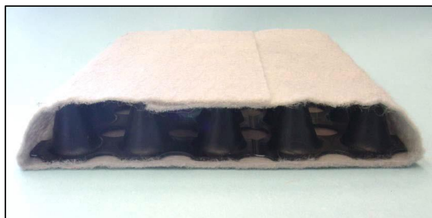
Figure 4.13 Geocomposite Edge Drain
