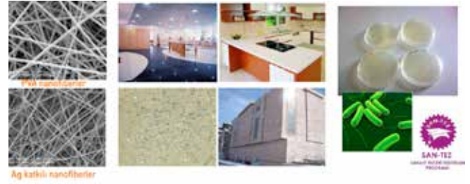
Nano boyutta Ag, ZnO, TiO 2 v.b. dolgu malzemesinin eklenmesi ile üretilen antibakteriyel özellikte kompozit malzemeler
