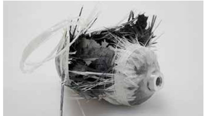
Patlatma testi sonrası tankın görünümü
