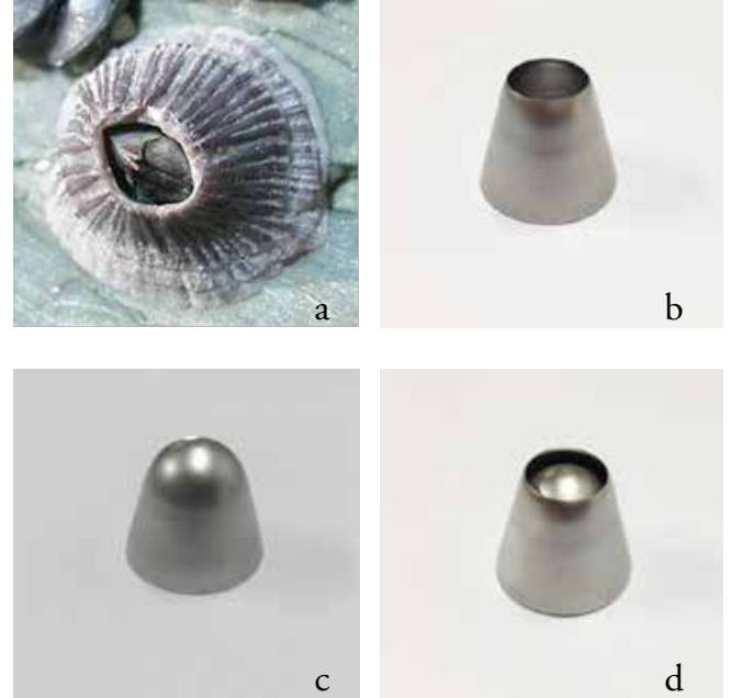
Şekil 2. (a) balan canlısı, (b) dış kabuk, (c) iç çekirdek ve (d) balan geometrisi.
