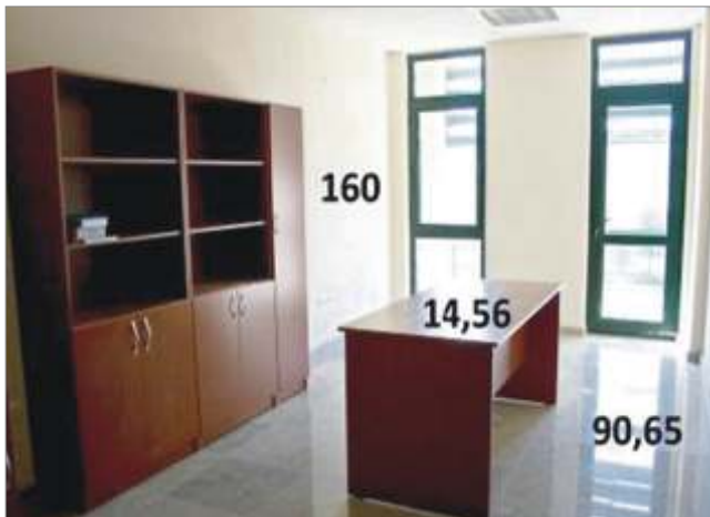
Şekil 1. İnceleme yapılan ofisin aydınlık düzeyi ve parlırtı değerleri
