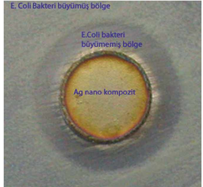
Şekil 4: Geliştirdiğimiz nano-gümüş içerikli kompozit
