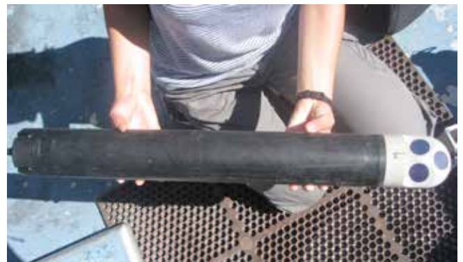
Şekil 6. Baraj gölünde tabana akım hız ölçer cihazlarının yerleştirilmesi
