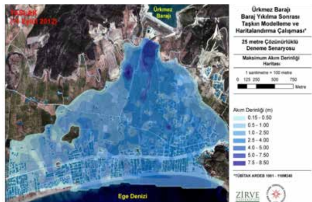
Şekil 2. Taşkın dalgasının sayısal modellenmesi
