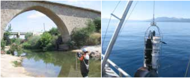
Şekil 4. Barajı besleyen nehirlerde yapılan akım ölçümleri ve gölde yapılan su kalitesi ölçümleri
