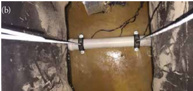
Şekil 4. (a) Deneylerde kullanılan farklı boyutlardaki lastik kırpıntılar, (b) Dolgu malzemesinden önce borunun kutuya yerleştirilmesi
