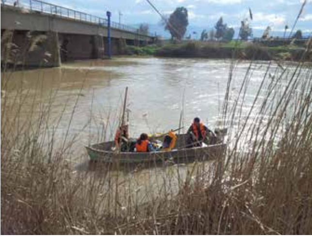
Şekil 7. Nehirde yatak profilinin (batimetri) ölçüm yoluyla çıkarılması
