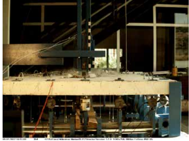
Şekil 1. Betonarme döşemelerde darbe deneyleri
