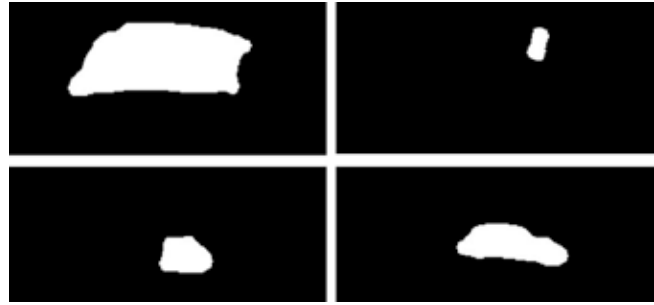
Şekil 2. Tümyönlü kameradan arkaplan çıkarımı ile elde edilen silüet örnekleri. Az yer kaplaması için imgeden ilgili yer kesilmiştir. Sol-üst: dolmuş, sağ-üst: yaya, sol-alt: motosiklet, sağ-alt: araba.
