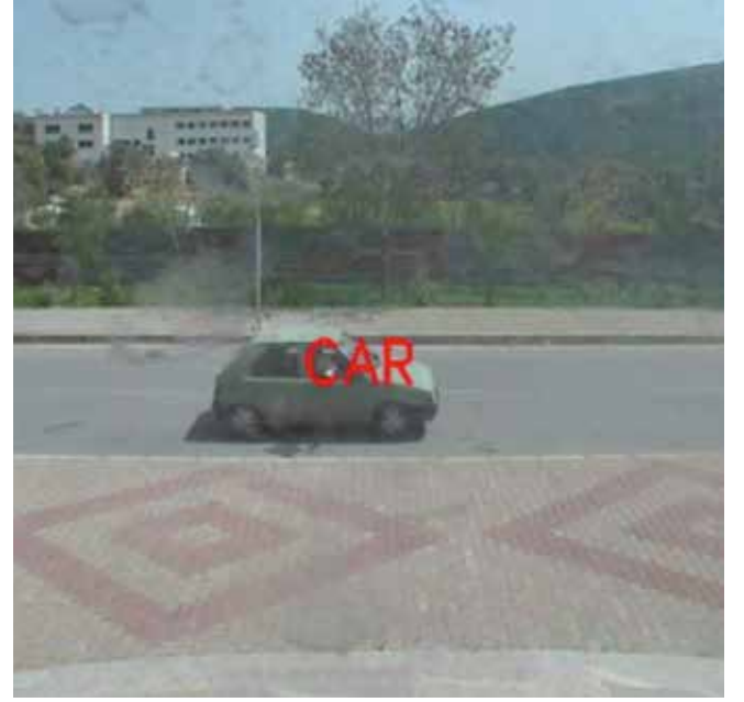
Şekil 3. Hibrit sistem sınıflandırma örneği. Sol: Tümyönlü kamerada ön sınıflandırma yapılmış ve nesne araba olarak etiketlenmiştir. Sağ: PTZ kamerada farklı öznelilikler ve ikinci bir sınıflandırma ile araç yine araba olarak sınıflandırılmıştır.
