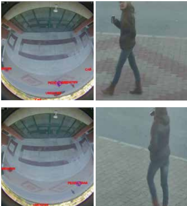
Şekil 1. Hibrit sistemde yüksek çözünürlüklü nesne takibi. Üst-sol: Hedef sınıfa (yaya) ait olan nesne saptanır. Üst-sağ: PTZ kamera o doğrultuya yönlendirilir. Alt-sol: Aynı nesnenin takibi devam eder. Alt-sağ: PTZ kamera hesaplanan pan, tilt ve zum değerleri ile nesneyi sürekli görüntüde tutar.
