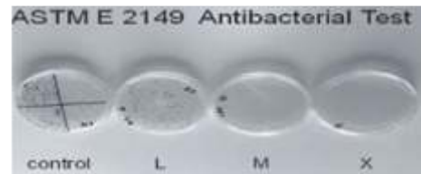
Şekil 4. Antibakteriyel test için E-coli bakterisinde bekletilen kumaşa örülmüş kaplanmış liflerin koloni sayma işlemi.
