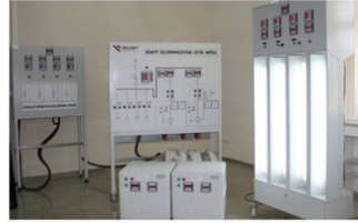
Aydınlatma ve Kompanzasyon Ünitesi
