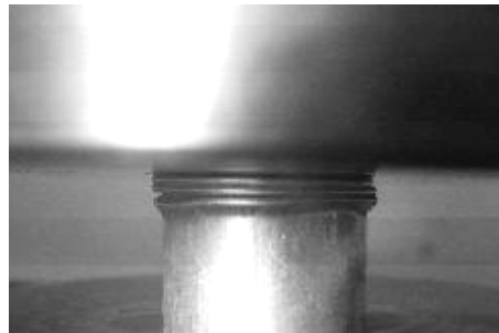
Şekil 9. Köpük (0,27 g/cm 3 ) dolu alüminyum tüpün ezilme davranışı (simetrik deformasyon).
