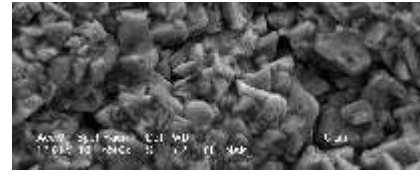
Şekil 23. 336 saat korozyona maruz kalmış St-37 karbon çeliği yüzeyinin TEM görüntüsü.
