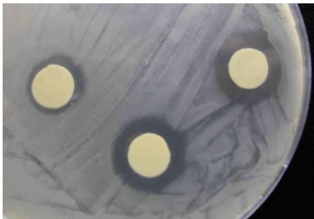
Fig. 8. Antimicrobial effect of zein films on E. coli (disc contents: 896 U (307 µg) lysozyme + 339 µg CPAE + 177 µg disodium EDTA · 2H 2 O).
