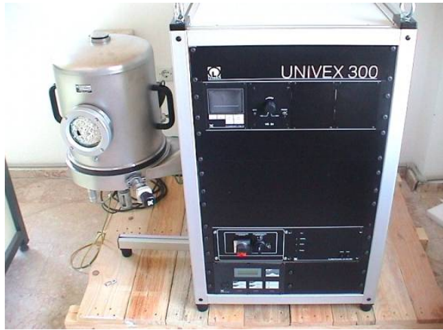
Şekil 3. Altın film elde etmek için kullanılan vakum buharlaştırıcı
