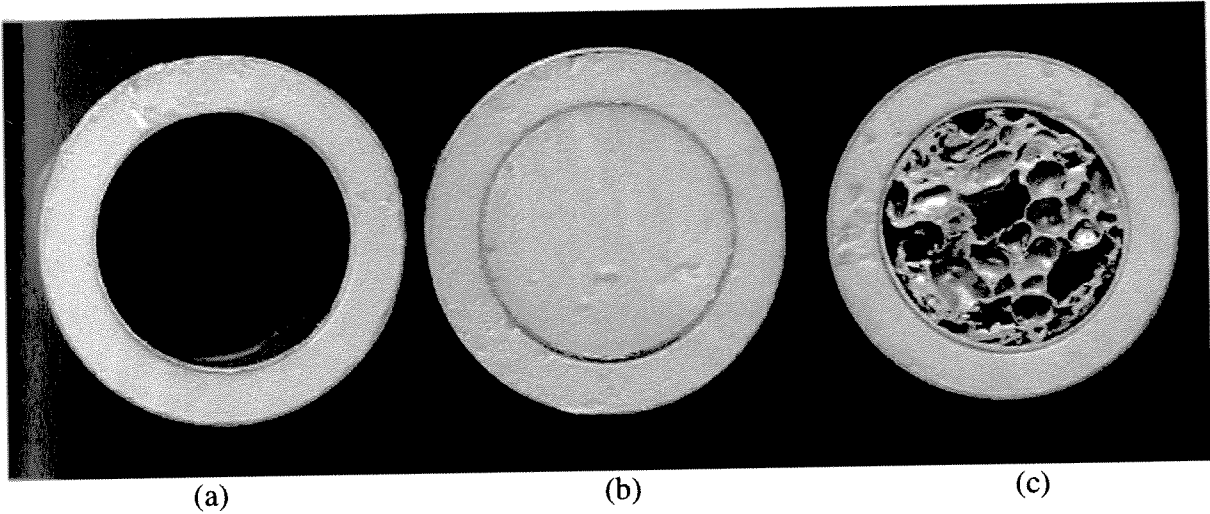
Şekil 1.25 Köpük dolu ikili tüp geometrileri (a) BPH, (b)BPP ve (c) BPA serileri.
