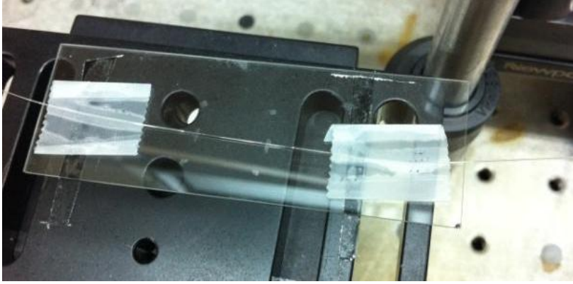
Şekil 3.15 Yanal Yüzeyi İnceltilmiş Optik Fiber ve Polimer Film Üzerinde Kırınım İndisi Izgarası Olan Deney Örneği
