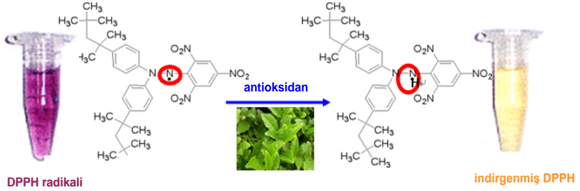
Şekil 1.8 DPPH yöntemiyle antioksidan aktivitenin belirlenmesi
