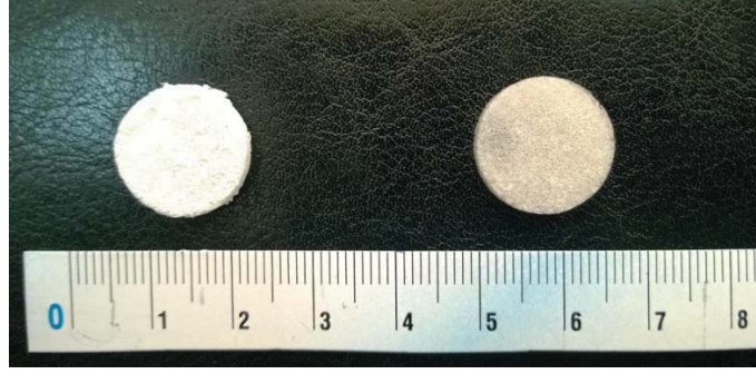
Şekil 9. %5 jelatin konsantrasyonu ile hazırlanan nanolifli (solda) ve katı duvarlı (sağda) doku iskelelerinin genel görünüşü.
