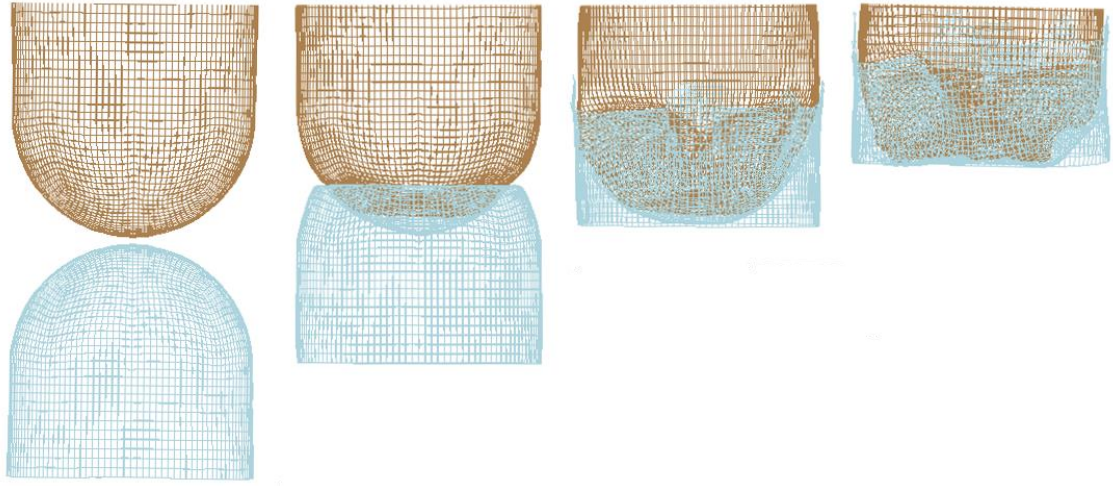
Şekil 154. Tip 6 sandviçte çekirdek malzemelerinin deformasyon şekilleri.
