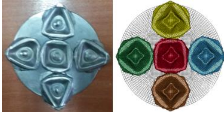
Şekil 95. R125T05 sandviç numunenin kuasi-statik – serbest test ve simülasyon sonucu ezilmiş şekli.
