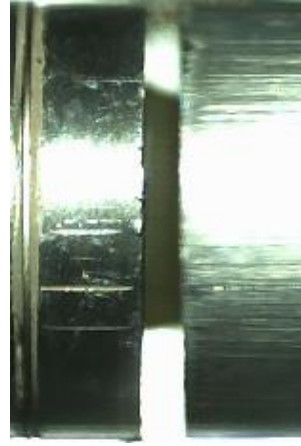
Şekil 44. 3450 \text{ s}^{-1} deformasyon hızında Poliüretan malzemesinin ezilme davranışı.
