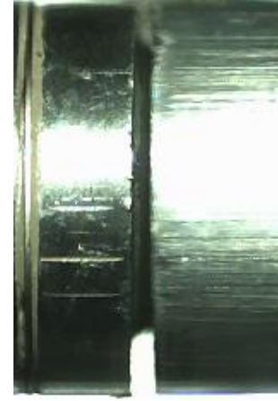
Şekil 44. 3450 \text{ s}^{-1} deformasyon hızında Poliüretan malzemesinin ezilme davranışı.
