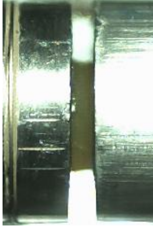
Şekil 43. 1925 \text{ s}^{-1} deformasyon hızında Poliüretan malzemesinin ezilme davranışı.
