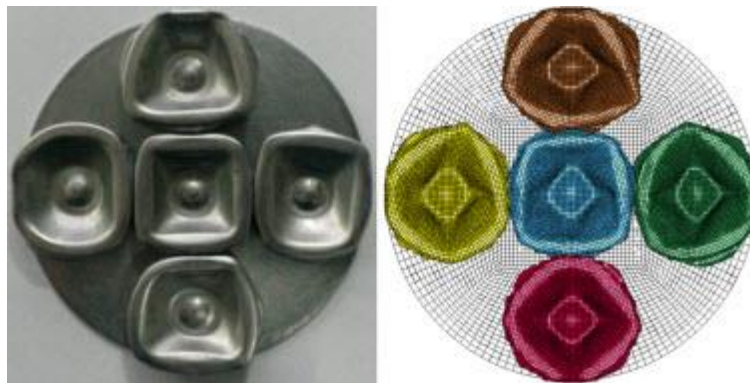
Şekil 96. R125T05 sandviç numunenin kuasi-statik – sınırlandırılmış (a) test ve (b) simülasyon sonucu ezilmiş şekli.
