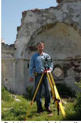
Şekil 42. Reflektörsüz elektronik takeometre ile ölçüm yapılması.
