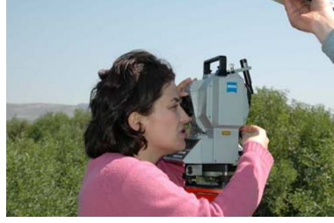
Şekil 42. Reflektörsüz elektronik takeometre ile ölçüm yapılması.
