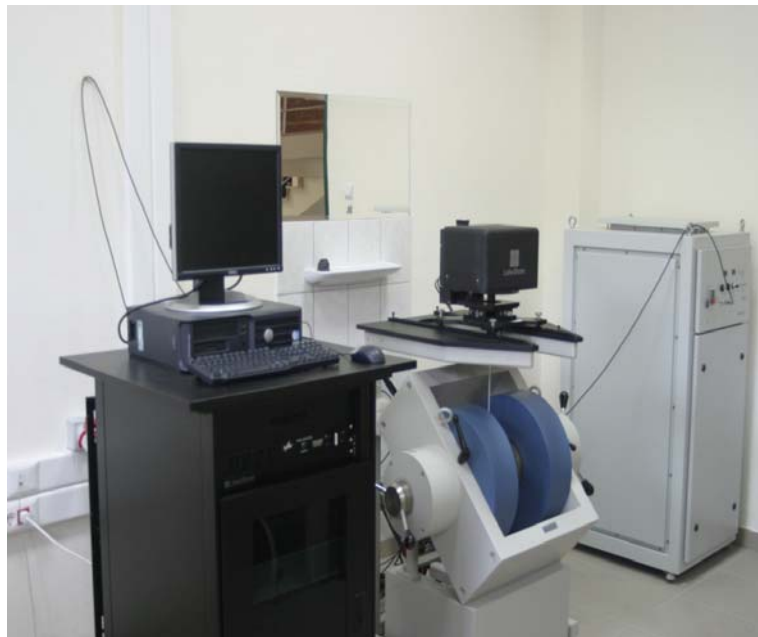
Şekil 2.3. Titreşimli örnek manyetometre sistemi (VSM).
