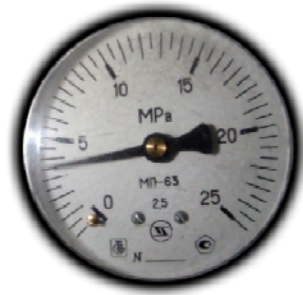
Şekil 3.18 ÇKH işleminde kullanılan basınç ölçer örnek resmi.
