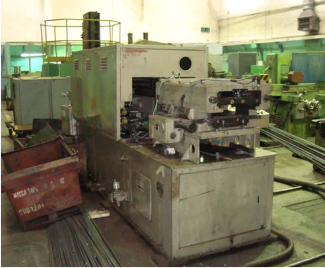
Şekil 3.11 Malzeme model parametreleri doğrulama deneylerinde kullanılan ÇKH makinesi.
