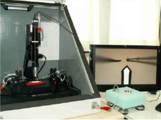
Şekil 3.16. Kolloid problemin yapımında kullanılan nanomanipulator.
