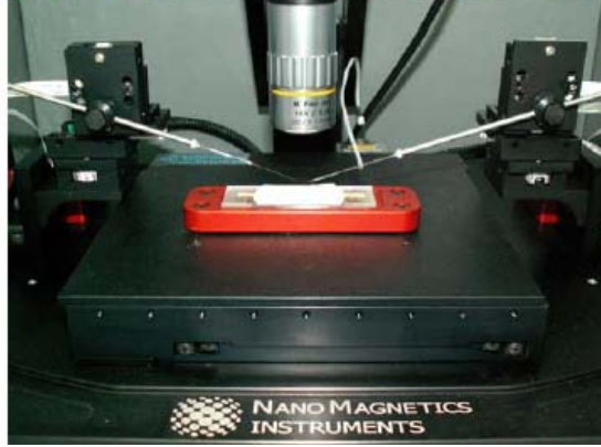
Şekil 3.16. Kolloid problemin yapımında kullanılan nanomanipulator.
