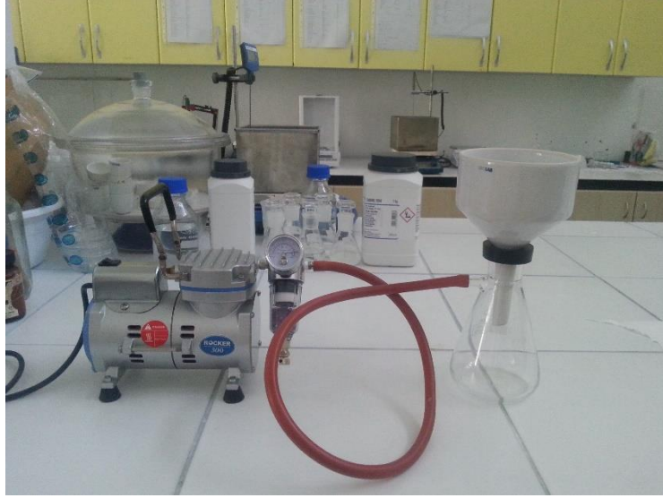
Şekil 8.5. Katı-sıvı fazları ayırımında kullanılan vakumlu filtrasyon düzeneği
