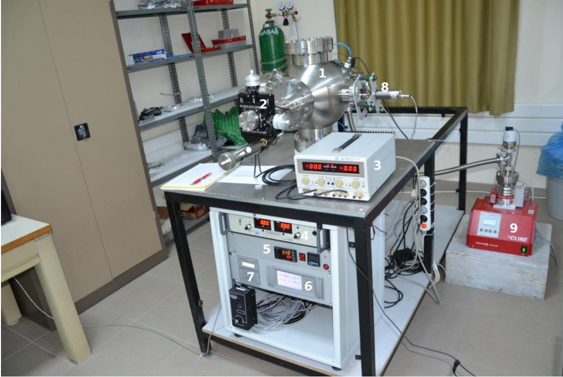
Şekil-11: Silisen büyütme deneylerinde kullanılan ultra yüksek vakum sistemi ve diğer bileşenler.
