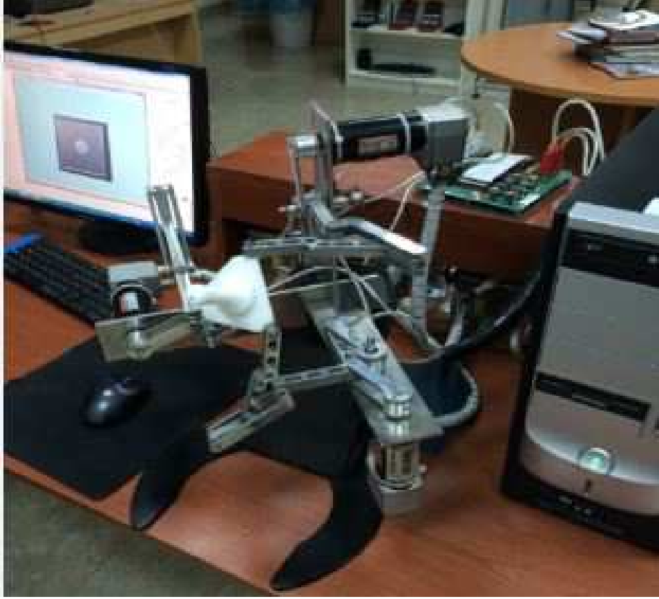
Şekil 5.8: Test düzeneği: Solda sanal bağımlı robot olarak kullanılan mobil robot ve ana robot olarak kullanılan HIPHAD robotu
