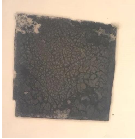
Şekil 81. Biriktirme yöntemiyle MgO alttaş üzerine kaplanan BSCCO filmin tavlama sonrası optik mikroskop görüntüsü.
