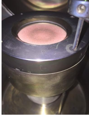
Şekil 54. RF magnetron sputtering sisteminde kullandığımız satın alınan Bi2212 hedef
