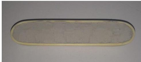
Şekil 46. Elde edilen homojen toz ve alümina kayık pota
