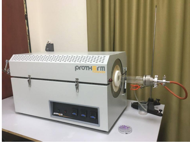
Şekil 73. Oksijen geçişli tavlama düzeneğinin resmi
