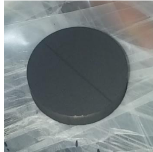
Şekil 55. Bi2212 Hedef (PLD sistemi için hazırlanan)
