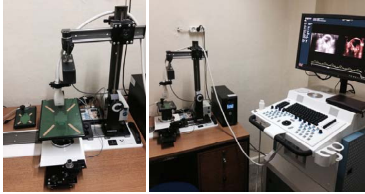
Şekil 21. Deneylerde kullanılan Vevo 2100 deney hayvanlarına dedike ultrasonografi sistemi, üç boyutlu transducer konumlandırma sistemi ve deney hayvanı stabilizasyon tablası.
