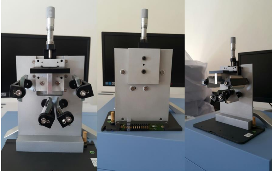
Şekil 1. Projede Ürettiğimiz Mikroşekillenmiş Si ATR-IR Düzeneği
