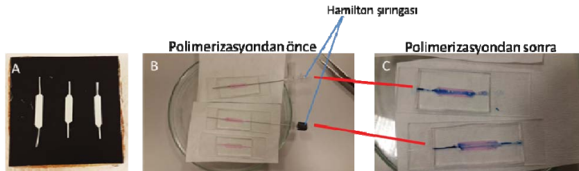
Şekil 123. Üç boyutlu LOC (Lab on a chip) oluşturma ve kalıp hazırlanma basamakları.
