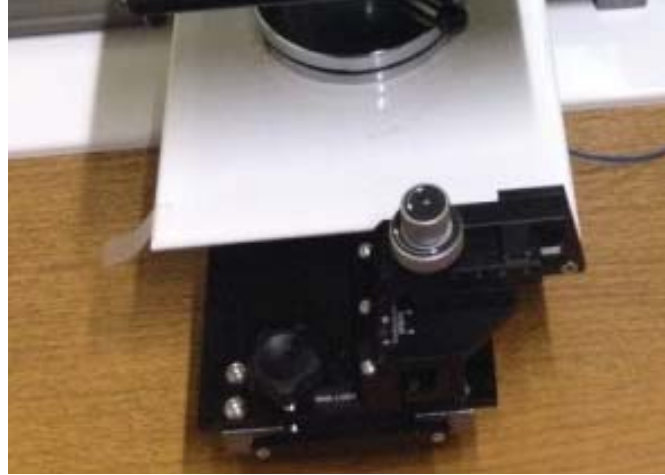
Şekil 16. Mikromanüpülör sistem üzerinde milimetre ve santimetre cinsinden uzunluk birimleri bulunan ve hayvan tablasının x ve y ekseninde milimetre boyutunda hareket etmesine olanak sağlayan sistemdir. Bu sistem ile tümörün tam orta noktasına konumlandırma yapmak mümkün olmaktadır.
