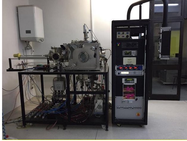
Şekil 6. 1 ODTÜ GÜNAM'da bulunan, yansıtma katman SiN kaplamanın yapıldığı RF Miknatıssal Saçırma Sistemi.
