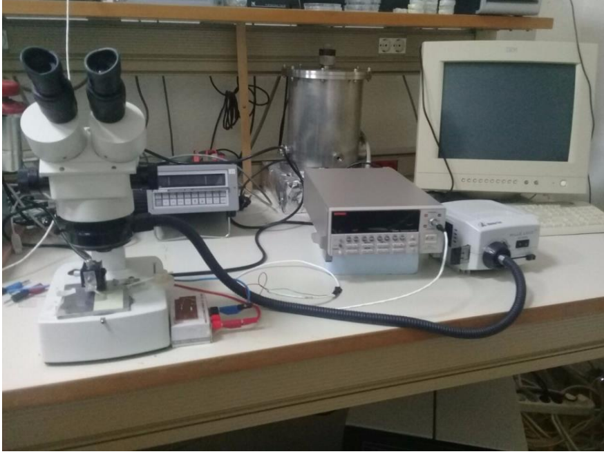
Şekil 2.10 I-V deney sistemi.
