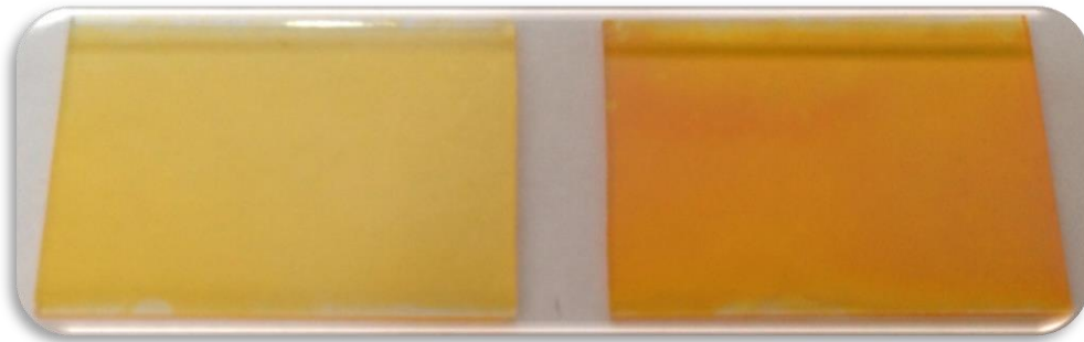
Şekil 5.4 CdS kaplı cam yüzeyler sarı olan (solda) ince ve turuncu (sağda) kalın filmidir.
