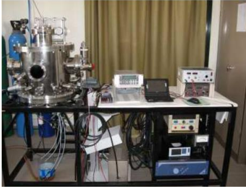
Şekil 3.5 Ti, Mo, Zn(O,S), ZnO ve AZO katmanlarının kaplanması için kullanılan mıknatıssal saçtırma sistemi.
