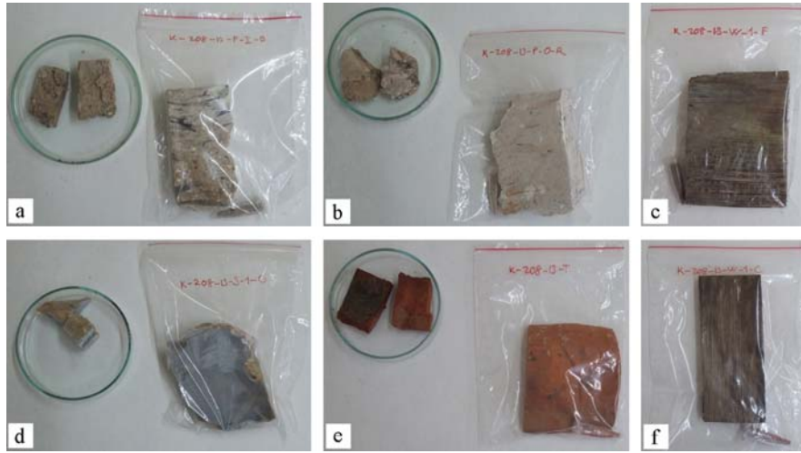
Şekil 7. Malzeme türü ve alındıkları yapıya göre kodlanmış örnek geleneksel yapı malzemeleri: a) iç sıva, b) dış sıva, c) zemin döşeme ahşabı, d) taş - yığma duvar, e) kiremit, f) tavan kaplama ahşabı (Sample traditional construction materials that were coded according to material type and source building: a) inner plaster, b) outer plaster, c) flooring wood, d) stone - masonry wall, e) roof tile, f) ceiling wood)
