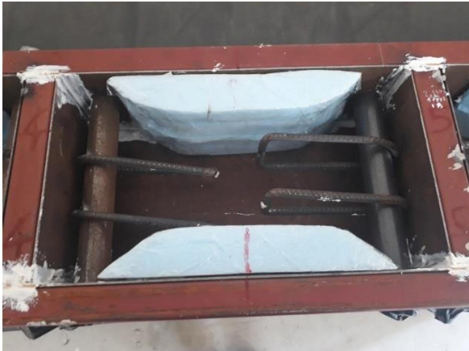
(d) T4 (hooked steel bars, free distance: 45 mm)
