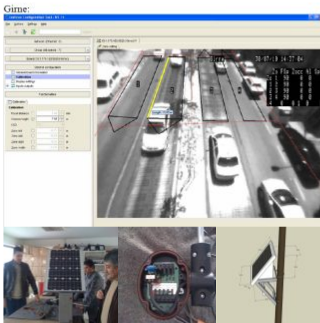
Şekil 4. GTD teknik özellikler, direklere kurulum ve boyut bilgileri
