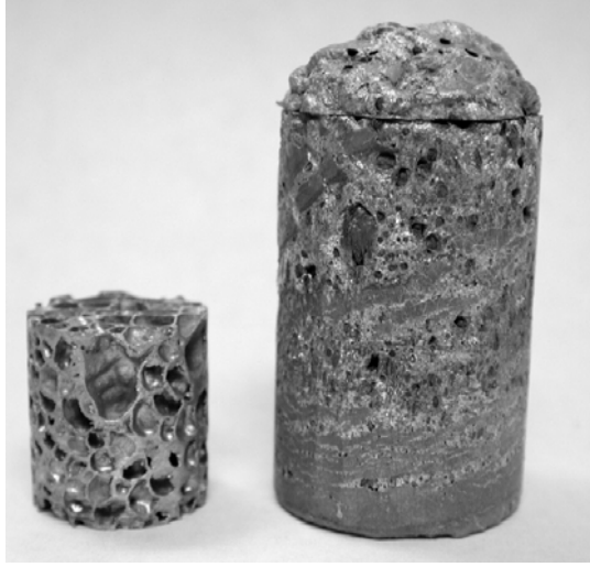
Şekil 5. Hazırlanan köpük numunesi (sağ) ve bu numuneden işlenen basma testinde kullanılan 20 mm çapındaki silindirik test numunesi (sol).
