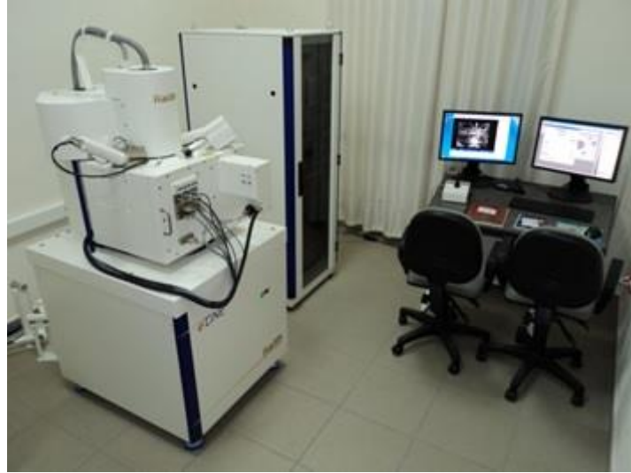
Şekil 3. 5 Eletron Demeti Litografisi sistemimizin fotoğrafı
