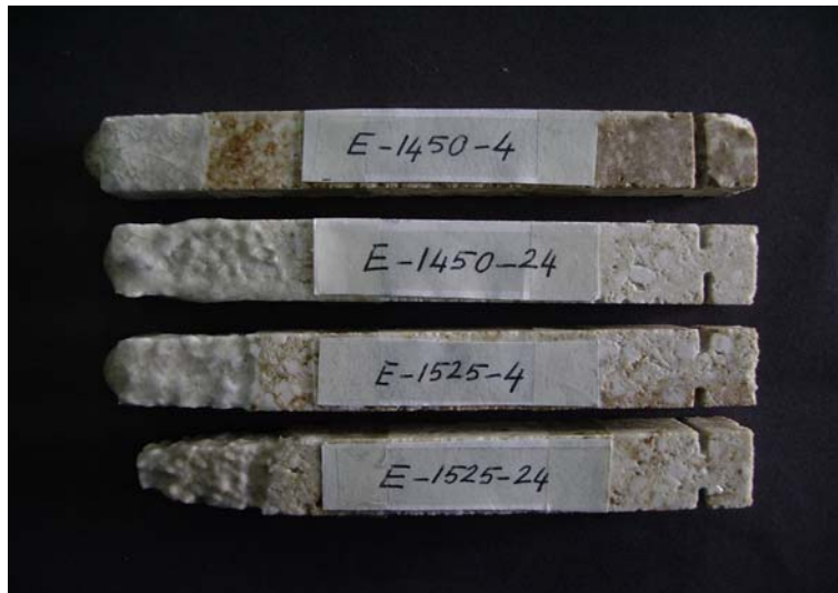
Şekil 25. E refrakter numunelerinin korozyon testi sonrası fotoğrafları.
