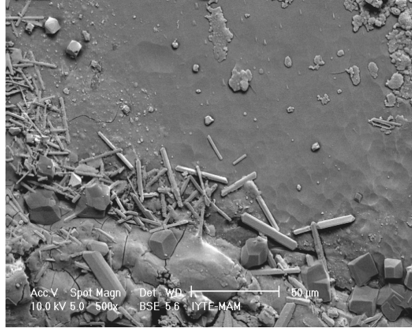
Şekil 38. 1450 °C' de 4 saat statik korozyon testine maruz bırakılan T refrakterin SEM(500X) görüntüsü (refrakter-frit arayüzeyi).
