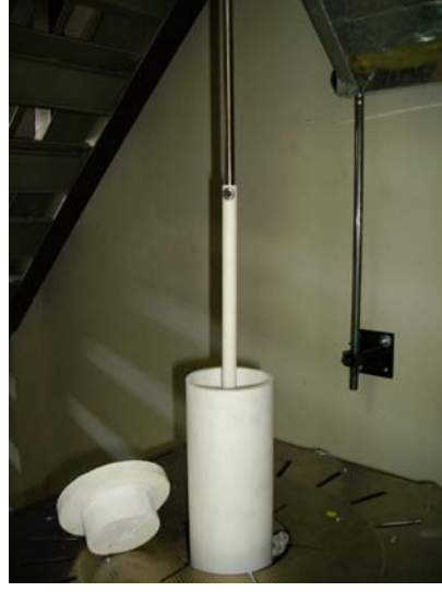
Şekil 20. Refrakter numunenin kroze içine daldırılması.
