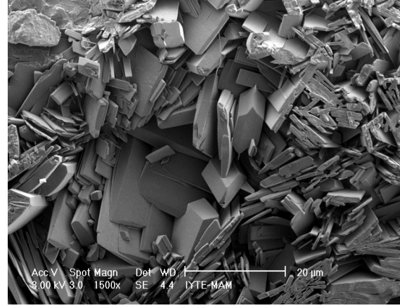
Şekil 32. Kaplanmamış mermer yüzeylerinin SO 2 ile olan (35 gün) reaksiyonu sonucu oluşan sülfatlanma ürünlerinin SEM görüntüleri
