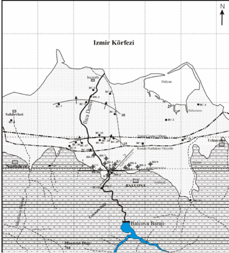
Şekil 3.16. Balçova Jeotermal Sahası kuyu yerleşimleri (Şimşek, 2005).
