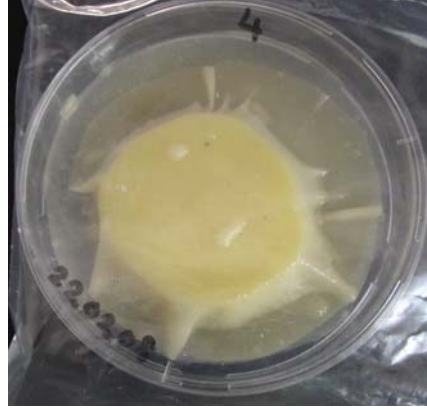
Şekil 4.22 Otuz gün saklama süresi sonunda G filmlerin peynir yüzeyindeki A. niger 'a etkisi a) sarılmamış kontrol peynir b) G kontrol film
