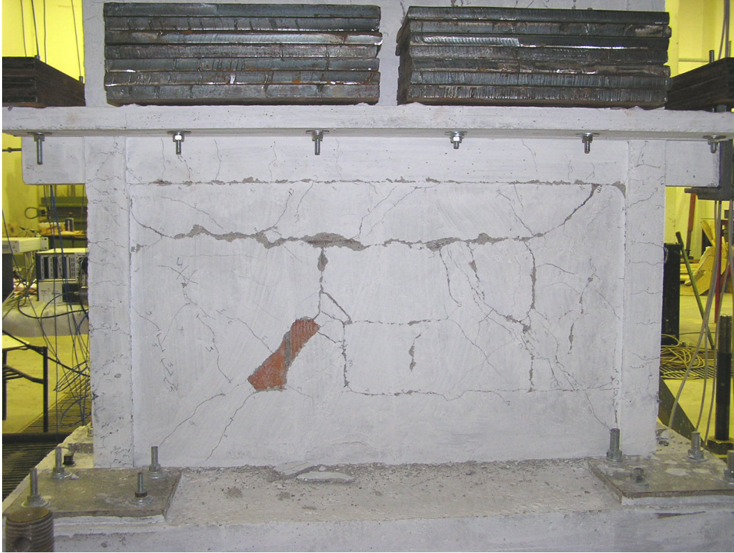
Şekil 4.40 Grup 4 yüklemeleri sonrası 1. kat güney yüzünde oluşan hasarlar
