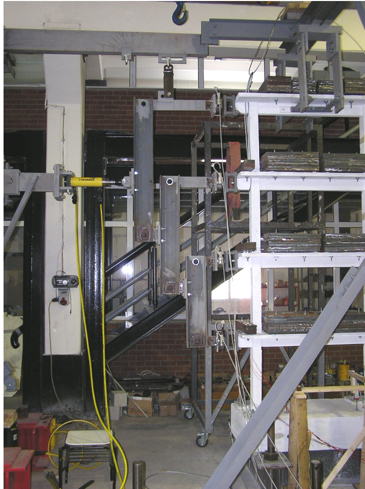
Şekil 4.4 Yükleme sistemi yük dağıtım kirişleri çerçeveye bağlı halde
