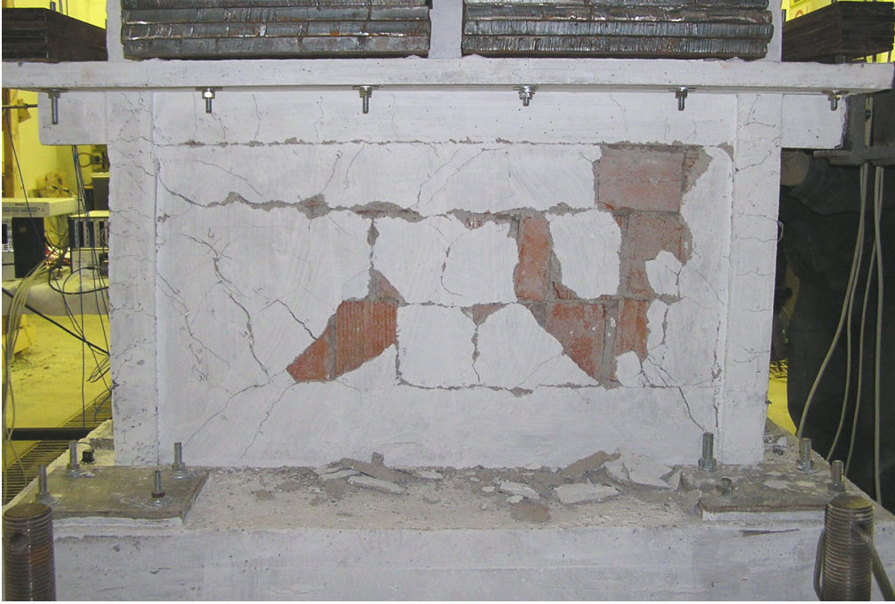
Şekil 4.43 Grup 5 yüklemeleri sonrası 2. kat güney yüzünde oluşan hasarlar
