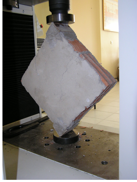
Şekil D.3 Dolgu duvar malzeme test numuneleri
