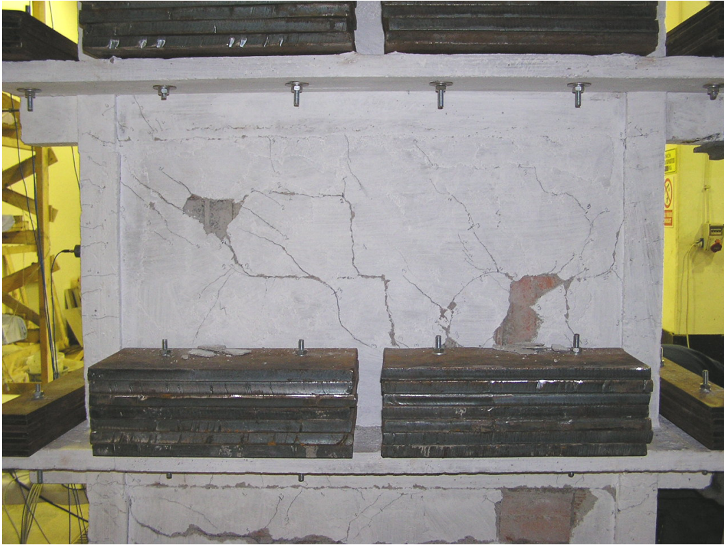
Şekil 4.42 Grup 5 yüklemeleri sonrası 1. kat güney yüzünde oluşan hasarlar
