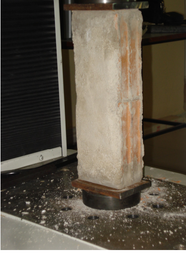
Şekil D.3 Dolgu duvar malzeme test numuneleri
