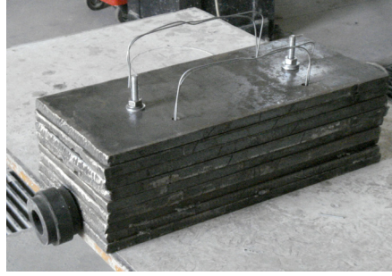
Şekil 6.4 Mimarlık A-bloğa darbe uyarısı vermekte kullanılan 92.6 kg'lık darbe çekici
