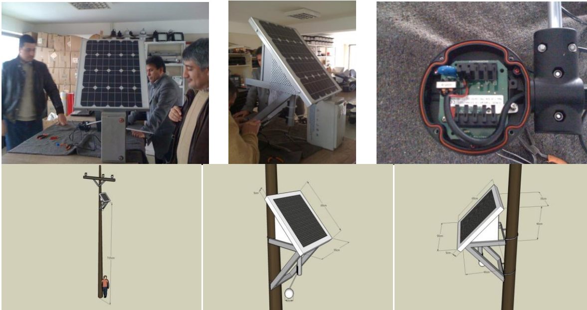
Şekil 3. 16 GTD teknik özellikler, direklere kurulum ve boyut bilgileri
