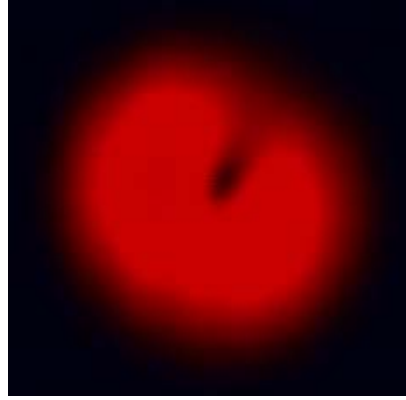
Şekil 3.7 Kırınım Iızgarası Sonrası Mod Profili
