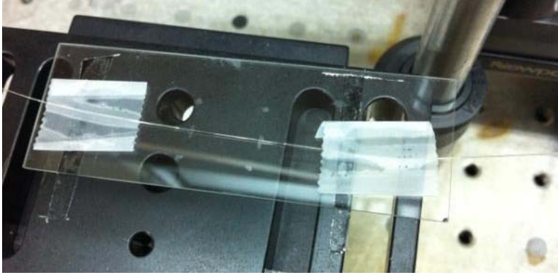
Şekil 3.2 Yanal Yüzeyi İnceltilmiş Optik Fiber ve Polimer Film Üzerinde Kırınım Indisi Iızgarası Olan Deney Örneđi
