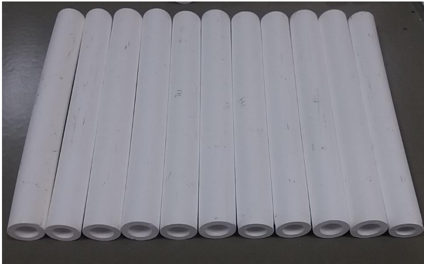
Şekil 4.21. Isıl işlem görmüş 200 mm uzunluğundaki tübüler alümina membran destekleri.
