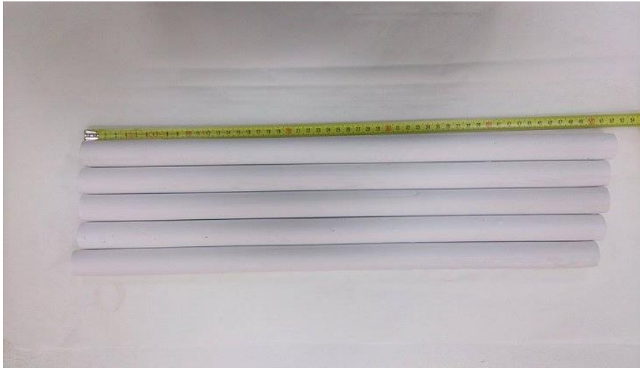
Şekil 4.20. Şekillendirilmiş yaş 500 mm uzunluğundaki tübüler alümina membran destekleri.
