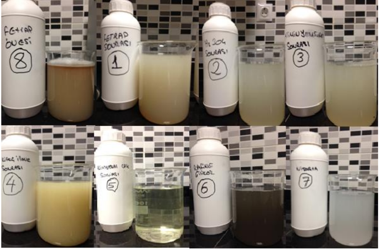
Şekil 3.12. Gıda endüstrisi atıksularının görsel değerlendirilmesi 1. Fat Trap sistemi ile yağ ayırma sonrası, 2. Sülfürik asit katımı sonrası, 3. Aluminyum sülfat katımı sonrası, 4. Kireç katımı sonrası, 5. Süzüntü suyu dengeleme tankı, 6. Glikoz içeren atıksu, 7. Nişasta içeren atıksu.
