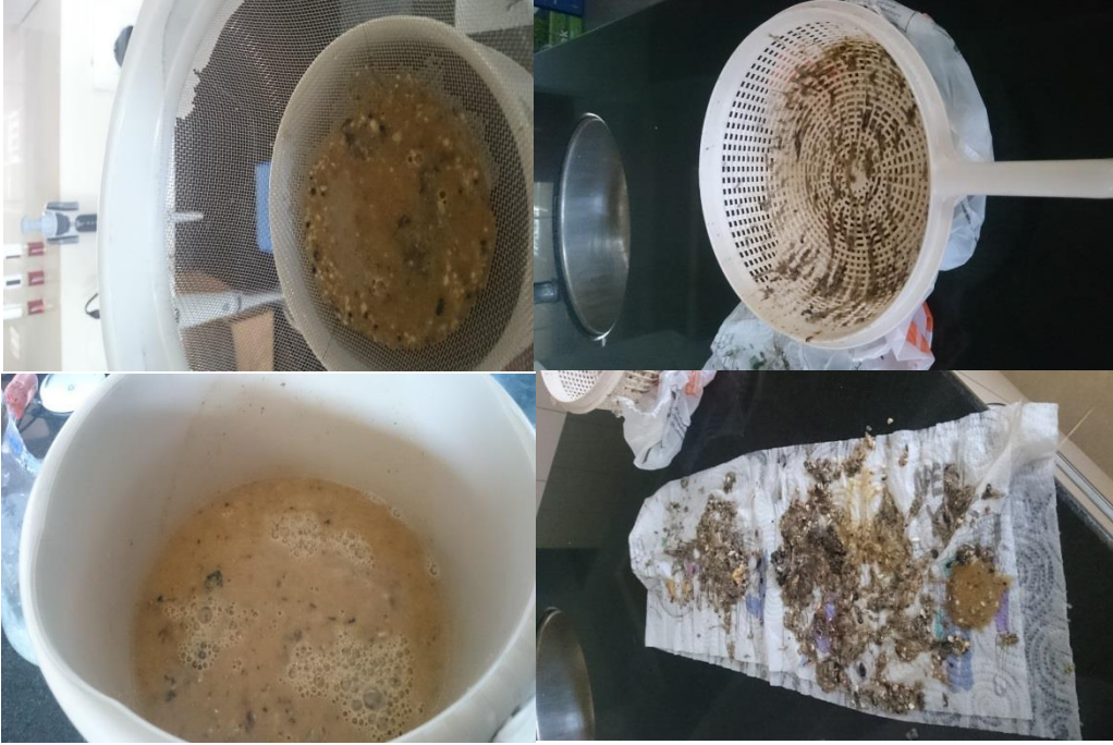
Şekil 4.93. Yağlı atık su numunesinin süzgeçten geçirme ve kaba filtreleme işlemi sonrası çıkan katı kirlilik unsurları.
