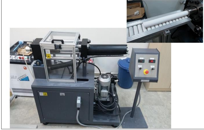
Şekil 3.4 Piston ekstrüzyon ile tübüler seramik membran desteklerin şekillendirilmesi.
