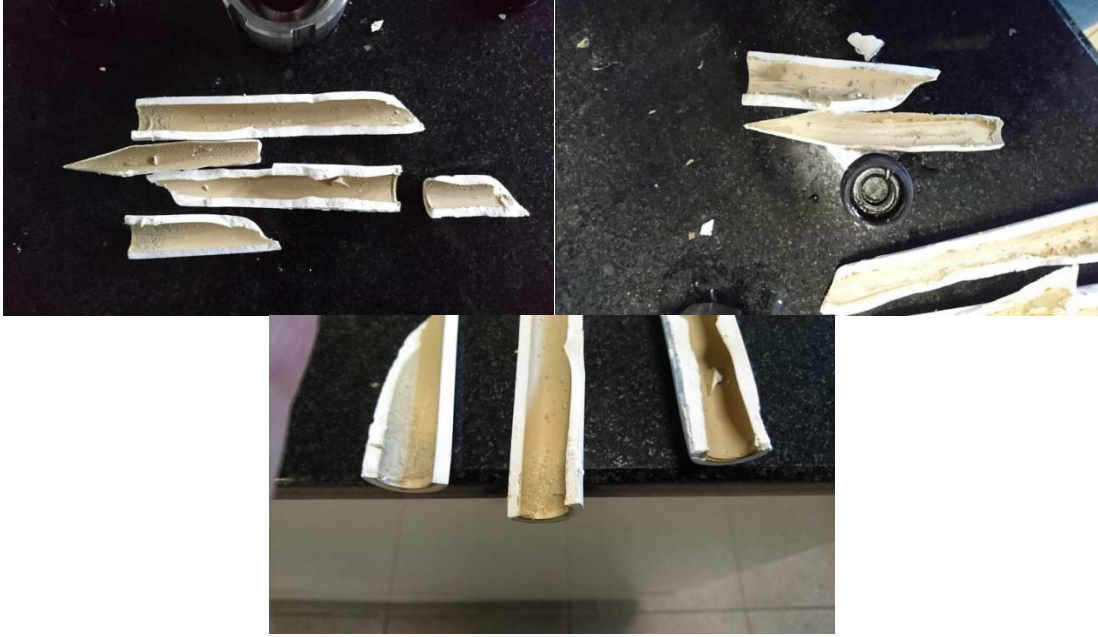
Şekil 4.115. Yağlı atıksu numunelerinin filtrasyon çalışması sırasında kırılan seramik membranın iç yüzeyi
