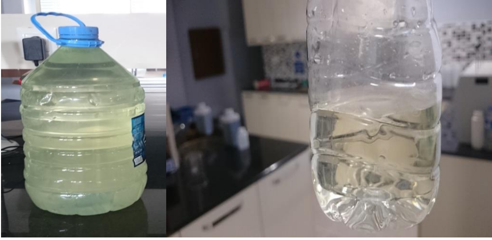
Şekil 4.90. Süzüntü suyu atıksu numunesi (a) ve UF işlemi ilk 10 dakikada elde edilen filtrat.
