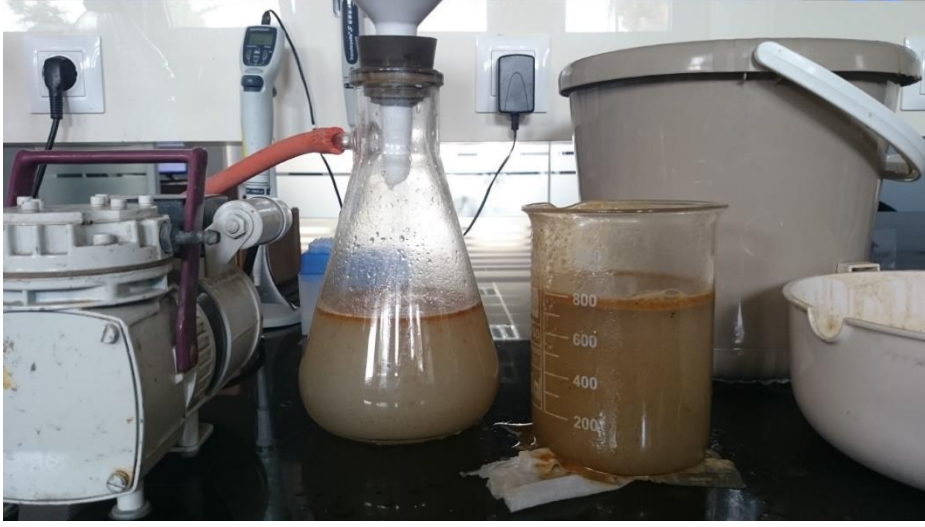
Şekil 4.92. Fat-trap öncesi yağlı atık su (beher), kaba filtreden süzme sonrası yağlı atık su (nuçe erleni).
