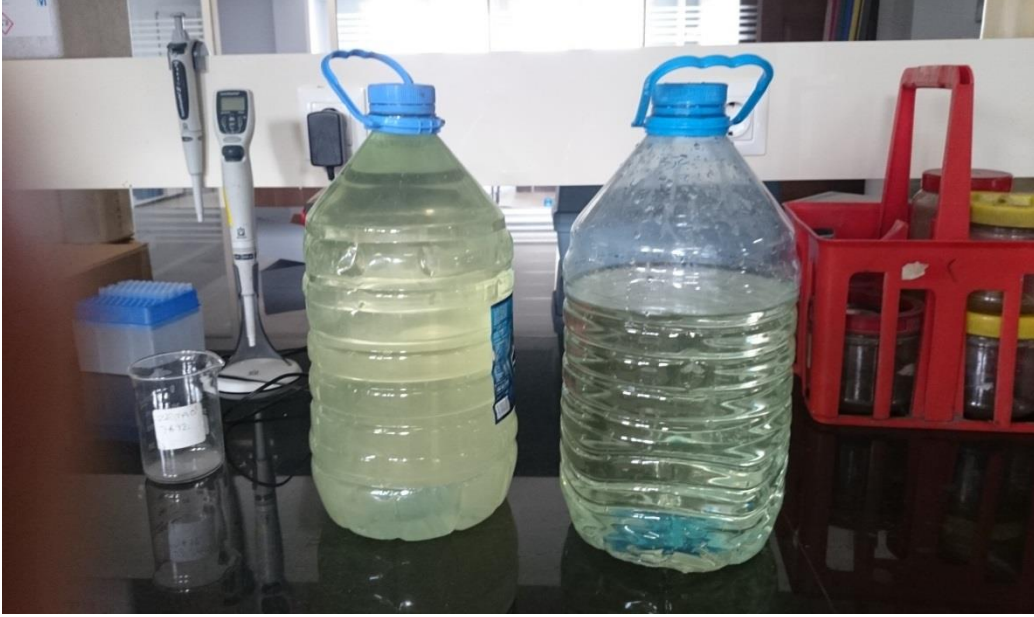
Şekil 4.87. Mikrofiltrasyon öncesi süzüntü suyu numunesi (solda), mikrofiltrasyon sonrası süzüntü suyu numunesi (sağda).
