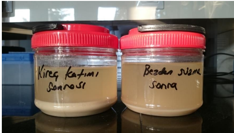
Şekil 4.91. Kireç katımı sonrası numunesinin bez ile süzme öncesi (solda) ve bez ile süzme işlemi sonrası (sağda).
