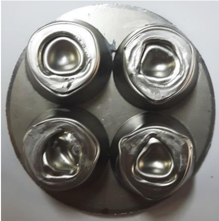
Şekil 92. Deneysel ve nümerik(dinamik) ezilmiş sandviç yapılar; (a) iç çekirdek, (b) dış kabuk ve (c) balan.
