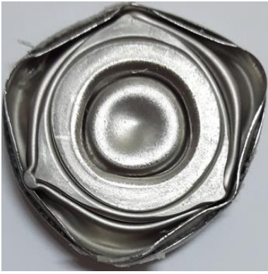
Şekil 73. Deneysel ve nümerik ezilmiş numuneler (statik); (a) iç çekirdek ve (b) balan.
