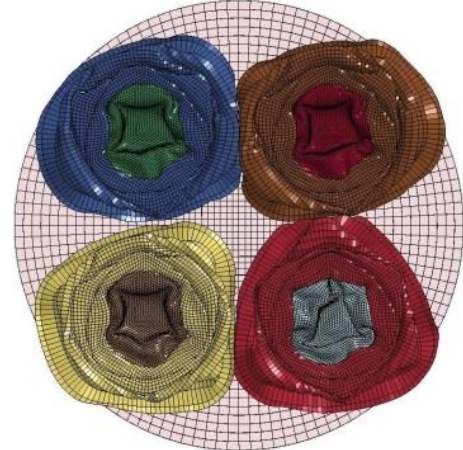
Şekil 88. Deneysel ve nümerik(statik) ezilmiş sandviç yapılar; (a) iç çekirdek, (b) dış kabuk ve (c) balan.
