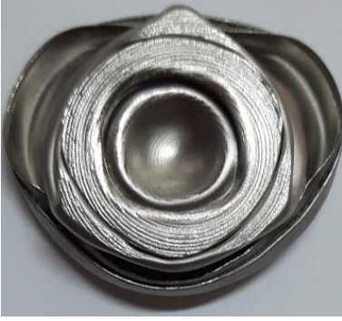
Şekil 77. Deneysel ve nümerik ezilmiş numuneler (dinamik); (a) iç çekirdek ve (b) balan.
