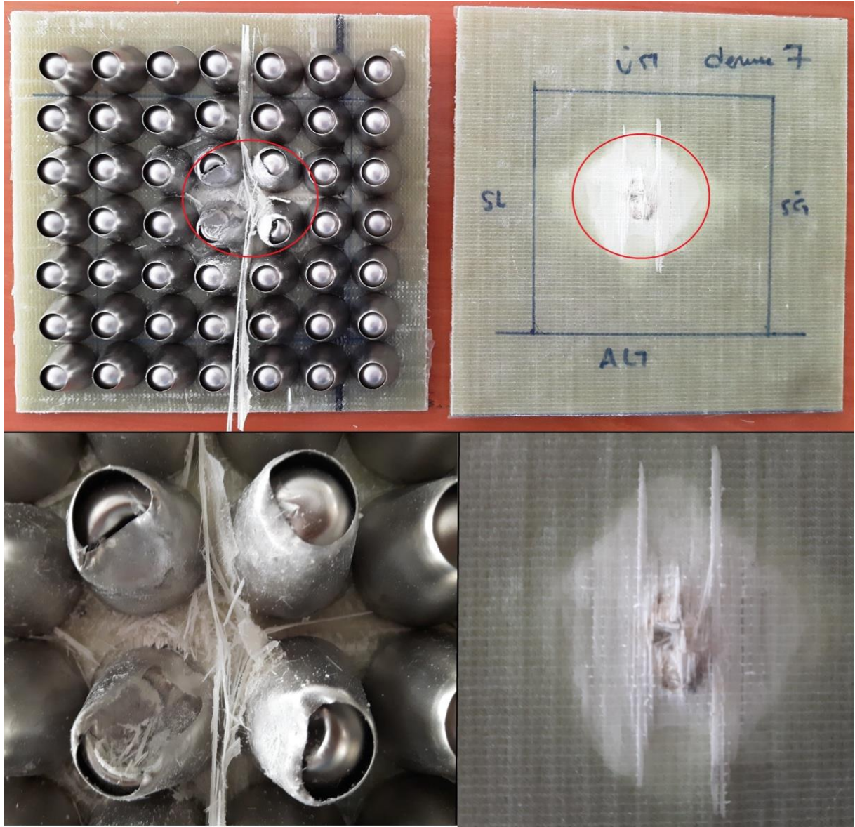
Şekil 107. Penetrasyon test sonucu (küre penetratör, 180 m/s).
