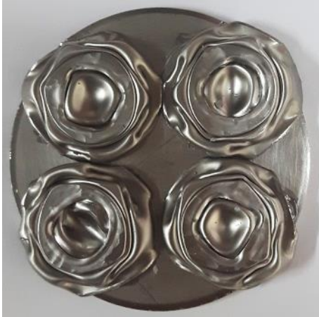
Şekil 88. Deneysel ve nümerik(statik) ezilmiş sandviç yapılar; (a) iç çekirdek, (b) dış kabuk ve (c) balan.
