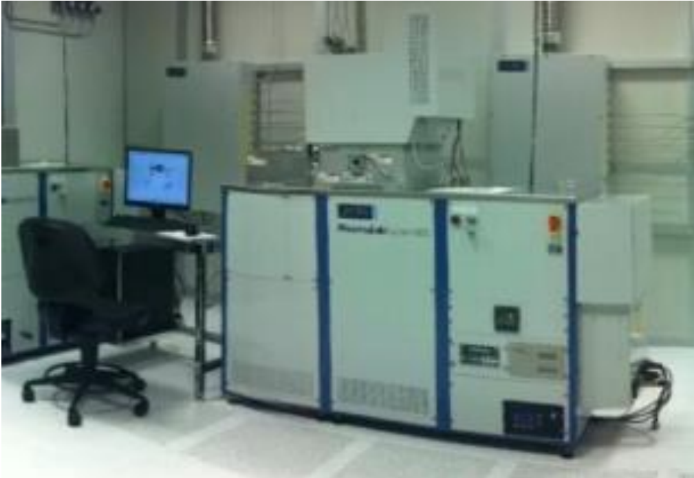
řekil-17: Oxford PlasmaLab System 100 ICP 300 reaktif iyon ařındırma sistemi
