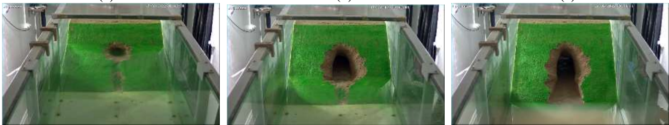
(a) (b) (c) (d) (e) (f) Fig. 9: The temporal development of the breach at the upstream (a) t=0 s, (b) t=5 s, (c) 15 s, (d) 25 s, (e) 60 s, (f) 315 s
