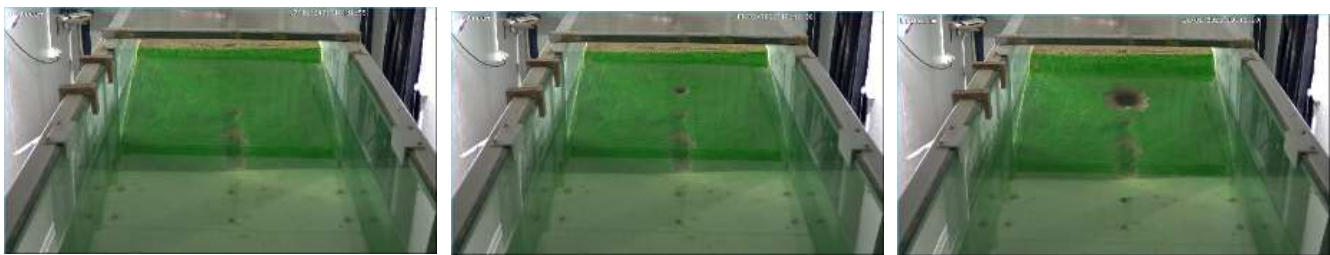
(d) (e) (f) Fig.8 (continued): The temporal development of the breach at the downstream (d) 25 s, (e) 60 s, (f) 315 s
