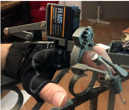
Şekil 11. Montajı tamamlanan dış iskelet sistemi
