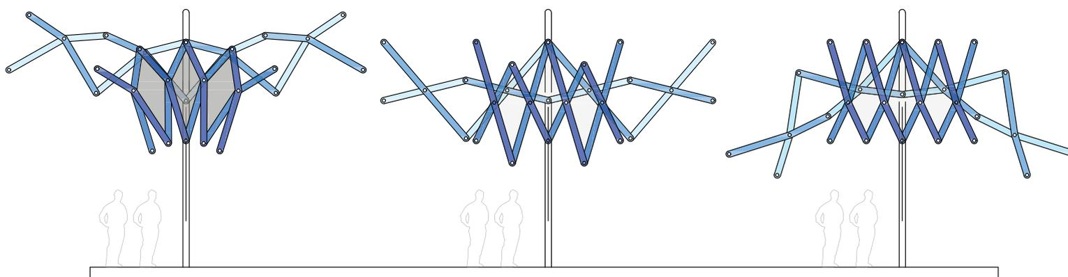
In unterschiedlichen Bewegungen resultierende Scherengestänge desselben Schleifentyps (Drachen)
