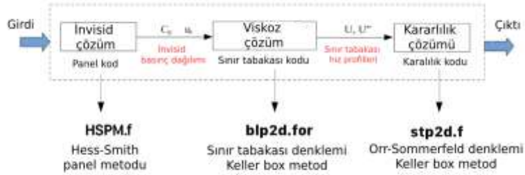
Şekil 2. Çalışmada kullanılan üç Fortran kodunun birleşimi ve kod akış diyagramı
